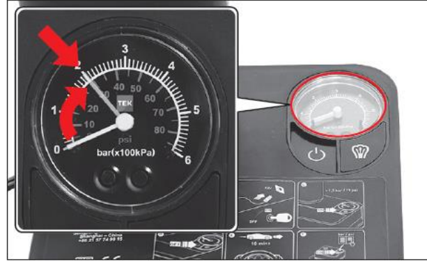
10- Hava basınç saatindeki standart basınç değeri 34psi (2,3 bar) olana kadar bekleyin.
