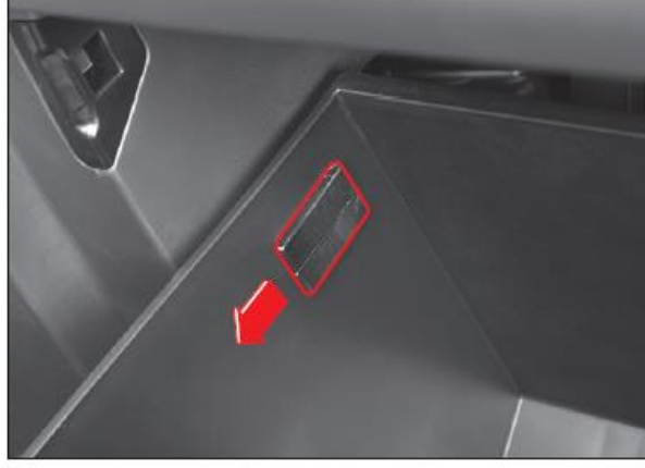
2.Torpido kutu tutucusunu ok şeklindeki gibi yönünde çekin
